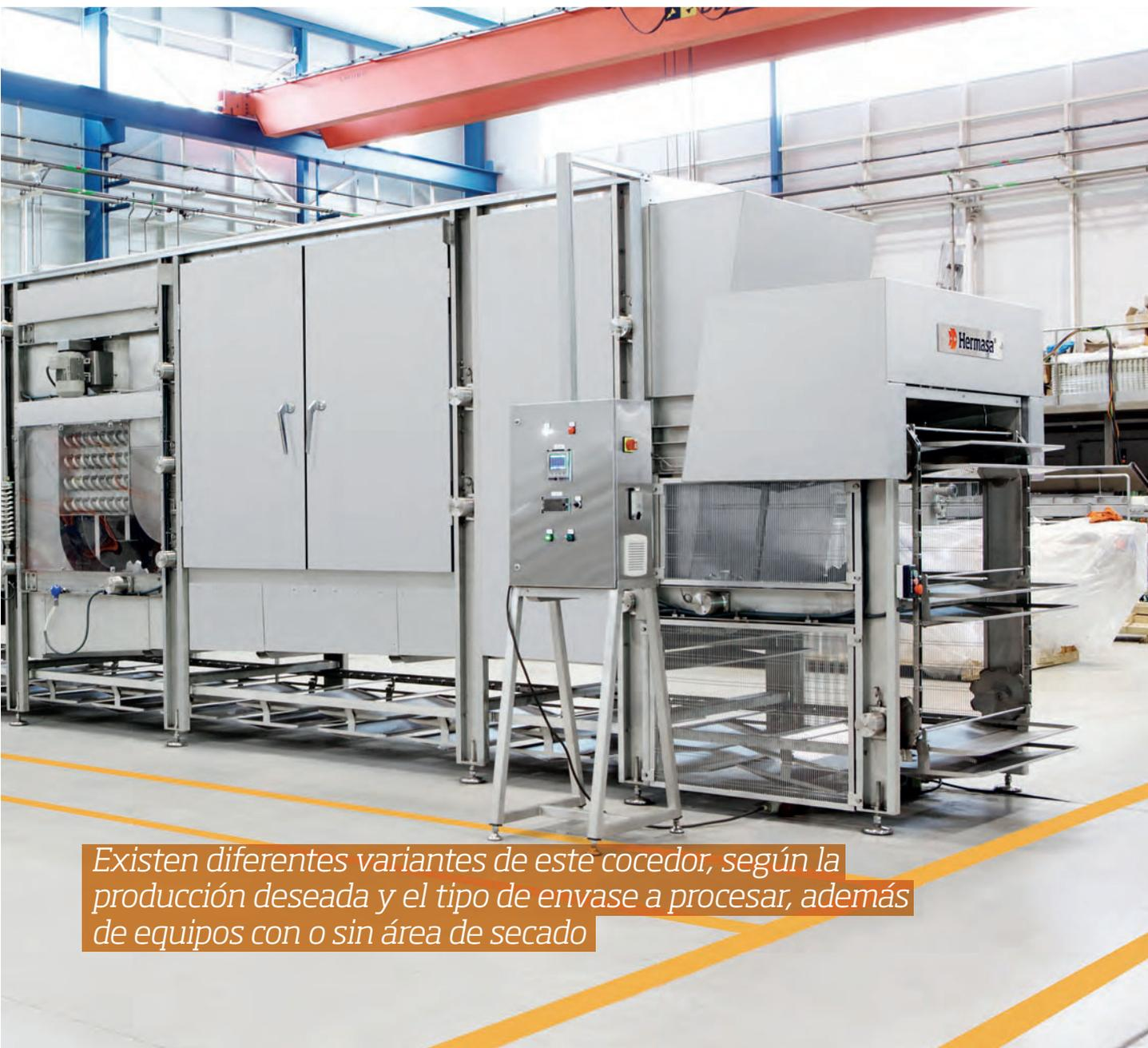
*Existen diferentes variantes de este cocedor, según la producción deseada y el tipo de envase a procesar, además de equipos con o sin área de secado*
