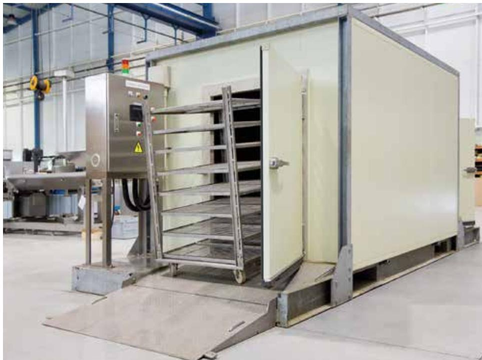
Le principe de fonctionnement s'appuie sur la recirculation de l'air et la vapeur d'eau à basse pression de manière homogène.
